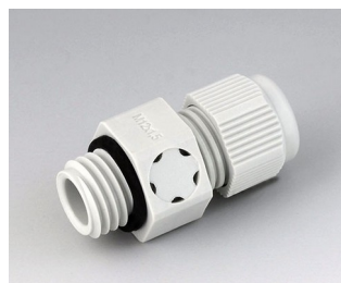
C2312917 Кабельный ввод M12x1,5, с компенсацией давления ПА светло-серый RAL 7035 IP 68
