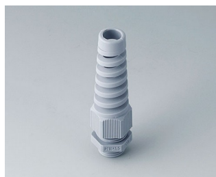
C2316518 Кабельный ввод M16 x 1,5, с защитой от изгиба ПА серебристо-серый RAL 7001 IP 68
