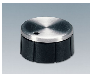
A1321260 Регулировочная ручка с боковым монтажным винтом ФФС (UL 94 V-0) черный/алюминиевый 21x10mm 6mm
