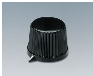
A1313560 Регулировочная ручка с боковым монтажным винтом ФФС (UL 94 V-0) черный RAL 9005 20x15,4mm 6mm
