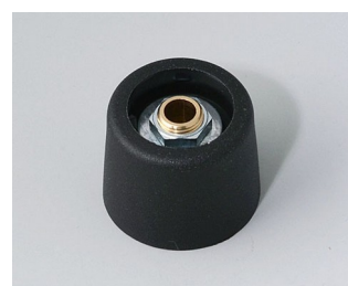
A3120069 Ручка COM-KNOB 20, без углубления ПА 6 неро 20x16mm 6mm
