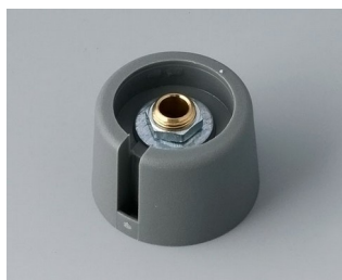
A3023048 Ручка COM-KNOB 23, с углублением ПА 6 вулкан 23x16mm 4mm
