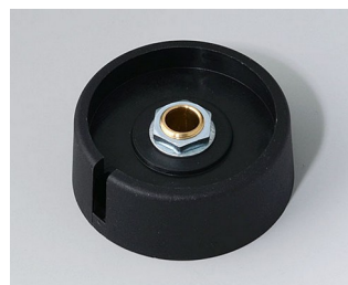
A3040069 Ручка COM-KNOB 40, с углублением ПА 6 nero 40x16mm 6mm
