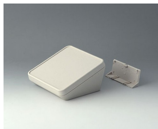
B4414207 PROTEC 140, исп. II АСА+ПК (UL 94 V-0) белый RAL 9002 140x140x76mm IP 65 opt.
